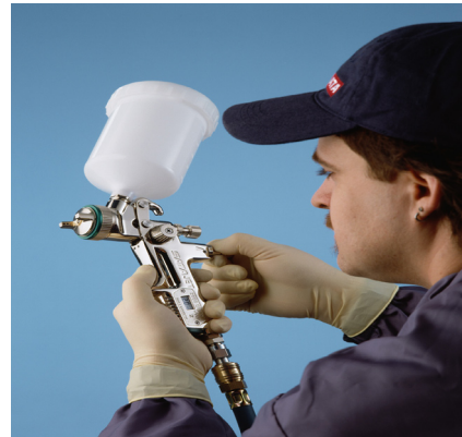
Bild 2-001 Das A und O vor jeder Lackierung: Das Überprüfen und Einstellen der Spritzpistole
